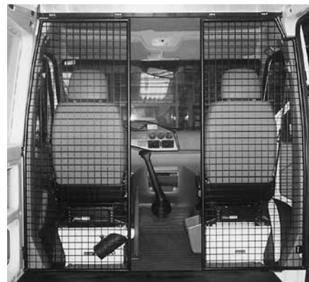
Paroi de séparation type B avec passage
