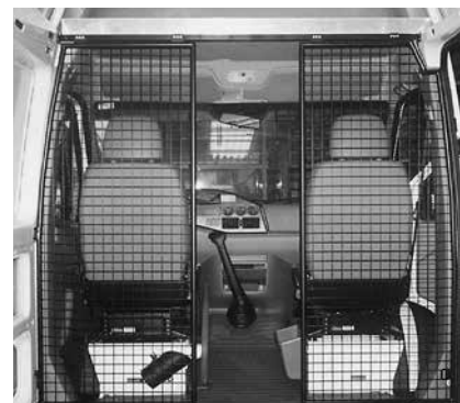
Paroi de séparation type B avec passage
