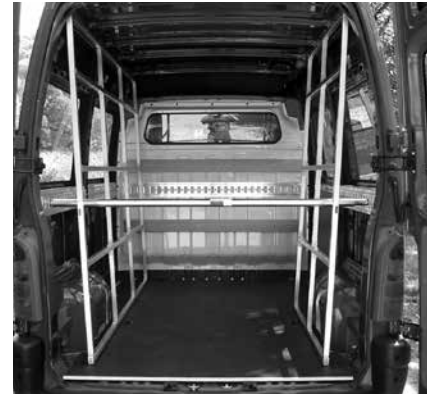
Innenreiff für Glastransport aus Aluminium
