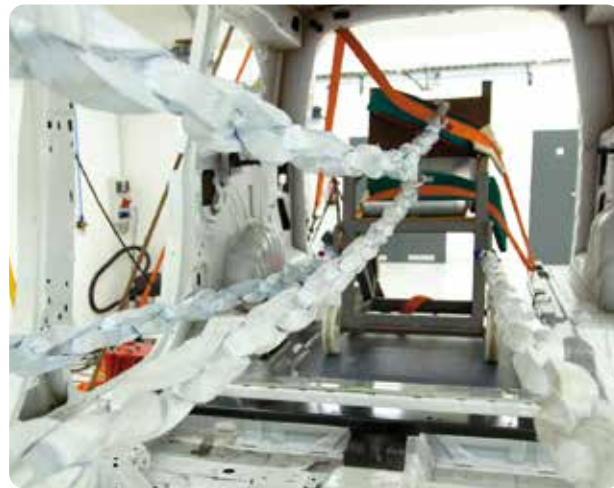
Zugversuche zur Prüfung der Rollstuhlverankerungen im Fahrzeug.
