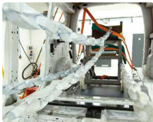
Zugversuche zur Prüfung der Rollstuhlverankerungen im Fahrzeug.
