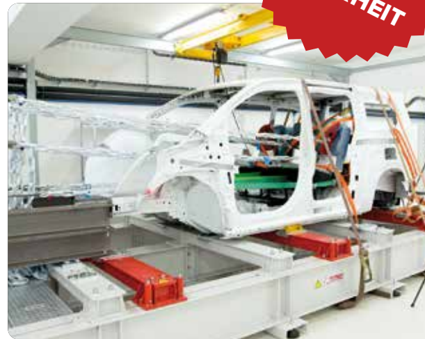
Prüfungen der zusätzlichen Sitze, Safetrans™ und SafetransPlus™ in Verbindung mit unserem Heckausschnitt.
