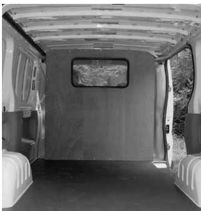
Paroi de séparation C
