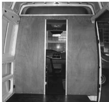
Trennwand C mit Durchgang spezial
