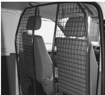
Paroi de séparation B avec passage
