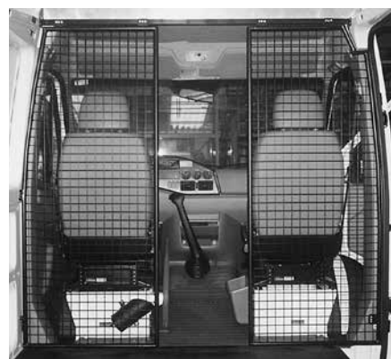
Paroi de séparation type B avec passage
