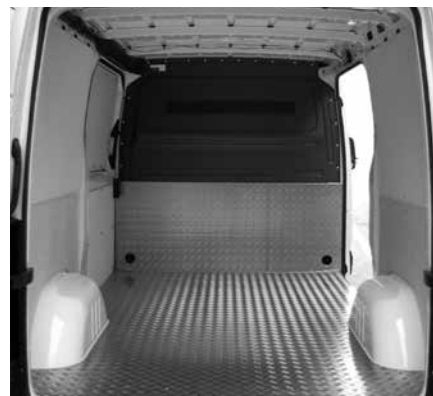
Trennwandverstärkung aus Alu-Riffelblech
