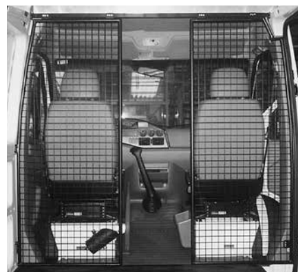
Trennwand B mit Durchgang
