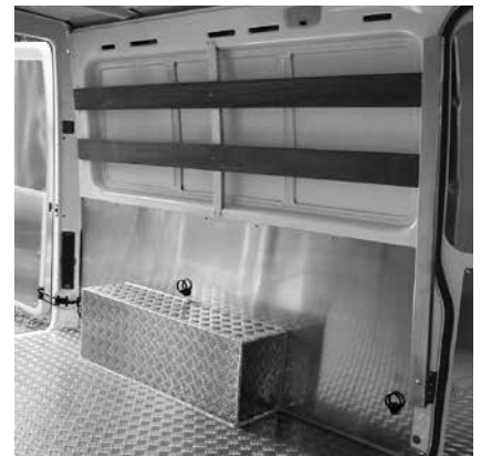
Riffelblechboden einteilig | Radkasten kubisch | Seitenwandverkleidungen unten | Hartholzplatten oben
