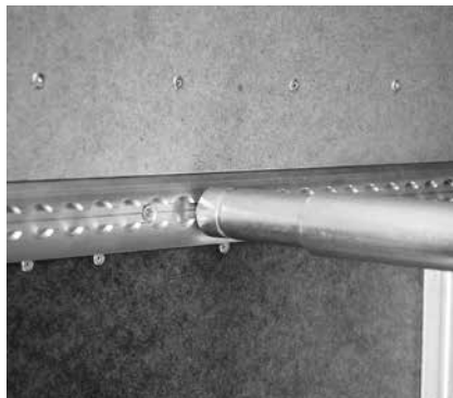
Airline-Zurrschiene mit Teleskop-Sperrstange
