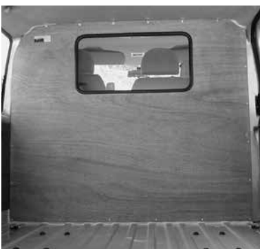
Trennwand C mit Fenster
