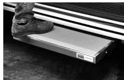
Marche vers la porte coulissante latérale
