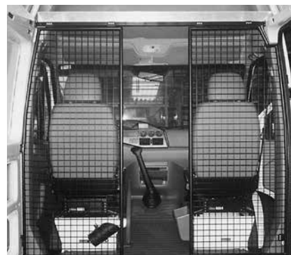
Paroi de séparation type B avec passage
