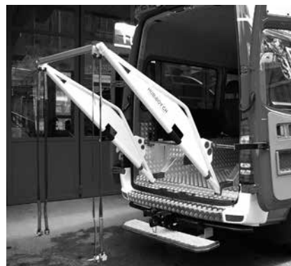
Véhicule de transport d'équipe avec Hubiboy
