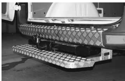
Marchepied arrière et pare-chocs renforcé
