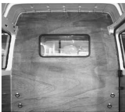
Paroi de séparation type C avec fenêtre
