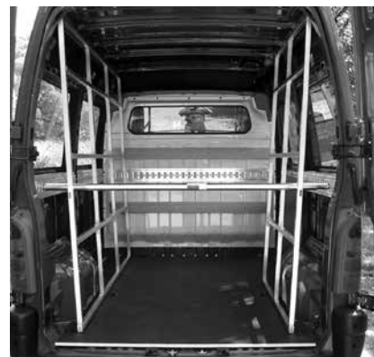
Innenreiff für Glastransport aus Aluminium
