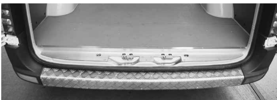
Türschwelle hinten anstelle Kunststoffteil und Stossbalkenschutz
