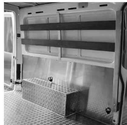
Riffelblechboden einteilig | Radkasten kubisch | Seitenwandverkleidungen unten | Hartholzlatzen oben
