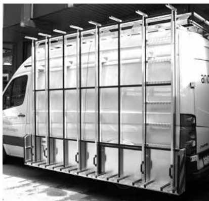
Seitliches Glasreiff aus Aluminium
