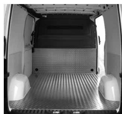
Trennwandverstärkung aus Alu-Riffelblech
