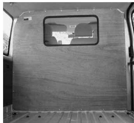
Trennwand C mit Fenster
