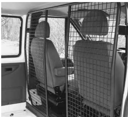
Trennwand B mit Durchgang
