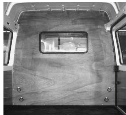
Trennwand C mit Fenster
