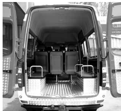
Véhicule de transport d'équipe avec banquettes longitudinales
