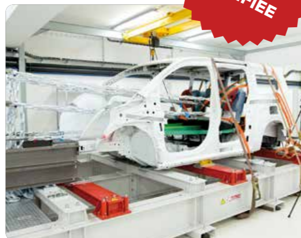
Contrôle des sièges additionnels, de Safetrans™ et SafetransPlus™ en rapport avec notre décaissement à l'arrière
