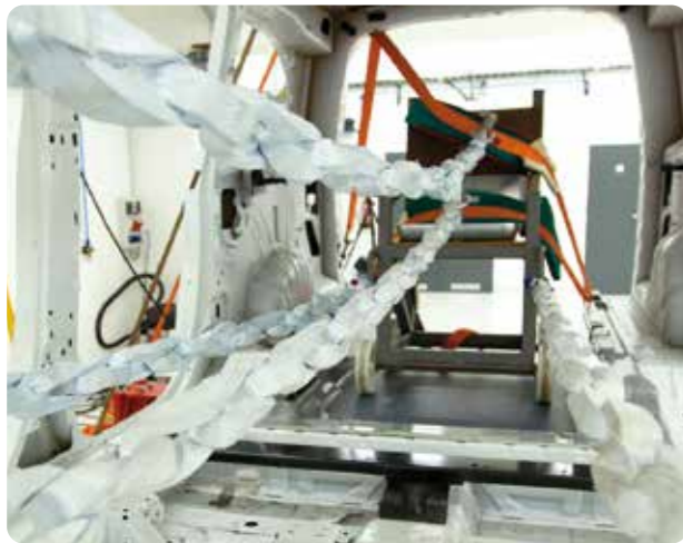
Zugversuche zur Prüfung der Rollstuhlverankerungen im Fahrzeug.
