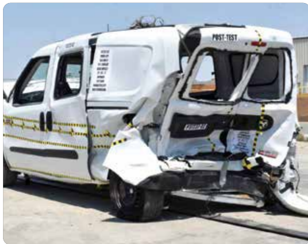
Crashtest: Nach dem Heckaufprall durch ein anderes Fahrzeug
