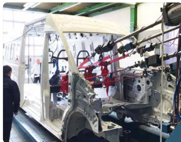
Prova di trazione sul veicolo. Viene testato l'ancoraggio dei sedili al pianale all'interno del veicolo stesso.
