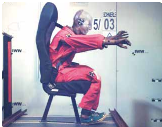
Crash test (test dinamico con slitta) con manichino. Vengono testati pianale e sedile.
