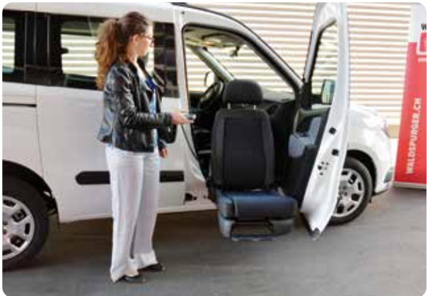
Sedile basculante Sedile girevole regolabile elettricamente o meccanicamente, agevola l'ingresso all'interno del veicolo, ad esempio di passeggeri anziani.
