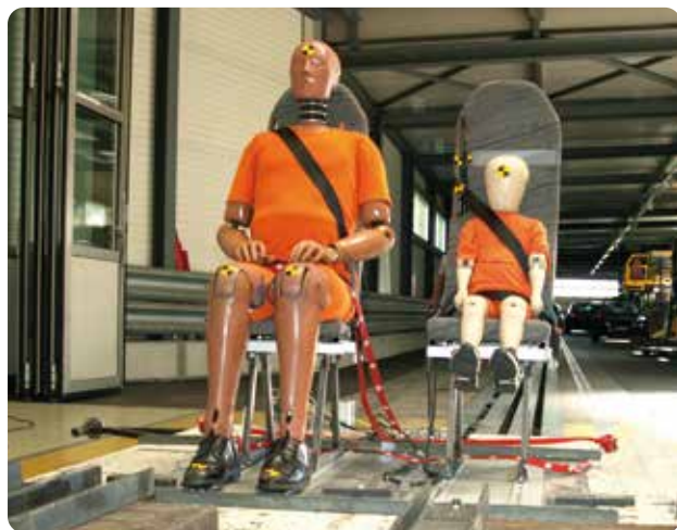
Verifica del fissaggio dei singoli sedili in abbinamento a un pianale esistente.
