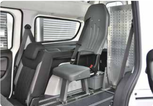
Sedili per il trasporto di detenuti Versione speciale, comprensiva di sistema di ritenuta delle manette.
