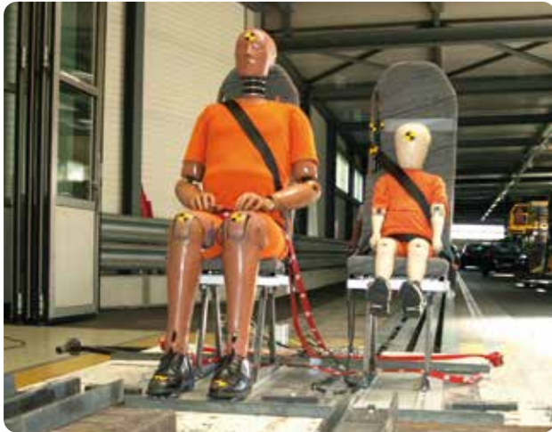
Test de l'ancrage de sièges individuels en rapport avec un plancher existant.
