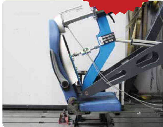
Test d'impact au niveau de la tête.
