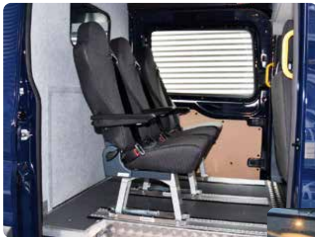
Sièges individuels démontables avec paroi de séparation supplémentaire et trappe intégrée. Idéal pour le transport de personnes et de matériel.
