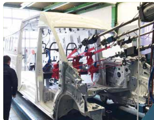
Zugversuch am Fahrzeug. Boden und Sitze werden auf ihre Verankerung hin im Fahrzeug selber getestet.
