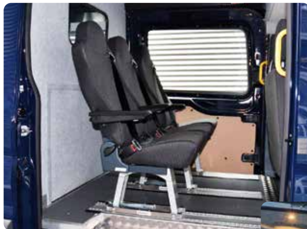
Demontable Einzelsitze mit zusätzlicher Trennwand und integrierter Durchladeklappe. Ideal für Personen- oder Materialtransport.
