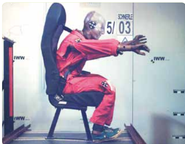
Crashtest (Schlittenversuch) mit Dummy. Getestet werden Boden und Sitz.
