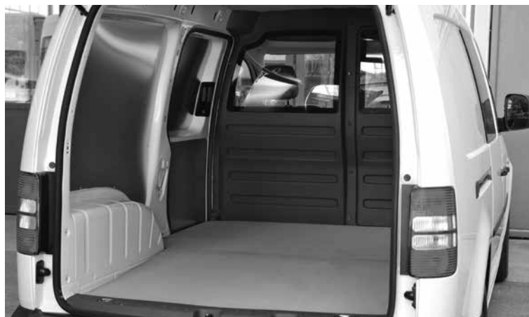
Revêtement du plancher et des parois latérales
