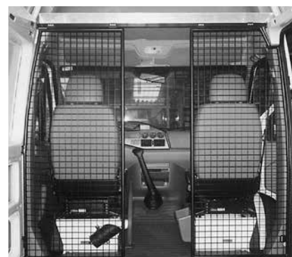
Paroi de séparation type B avec passage
