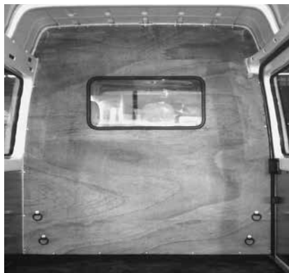
Trennwand C mit Fenster
