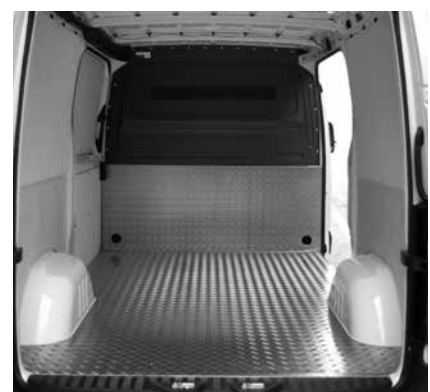
Trennwandverstärkung aus Alu-Riffelblech
