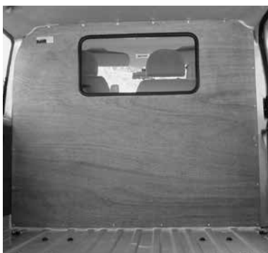
Paroi de séparation type C avec fenêtre
