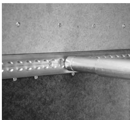
Airline-Zurrschiene mit Teleskop-Sperrstange
