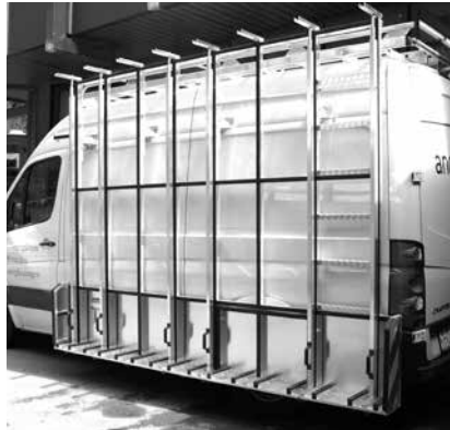
Seitliches Glasreiff aus Aluminium
