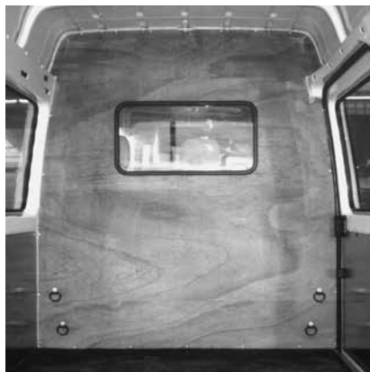
Trennwand C mit Fenster
