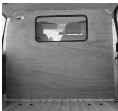
Paroi de séparation type C avec fenêtre
