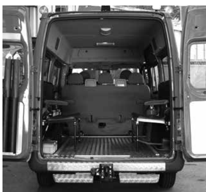
Véhicule de transport d'équipe avec banquettes longitudinales
