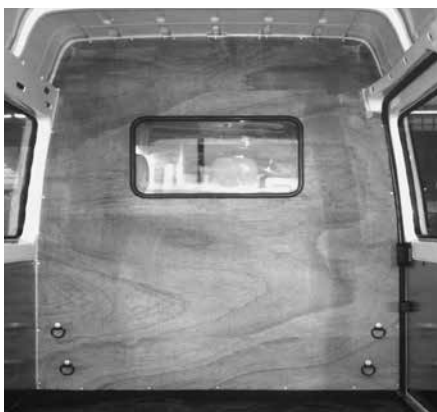
Paroi de séparation type C avec fenêtre
