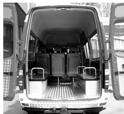
Véhicule de transport d'équipe avec banquettes longitudinales
