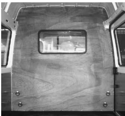
Paroi de séparation type C avec fenêtre
