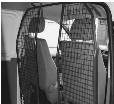
Paroi de séparation B avec passage
