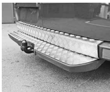
Revêtement de la marche
