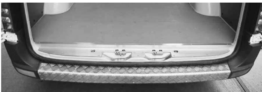
Türschwelle hinten anstelle Kunststoffteil und Stossbalkenschutz
