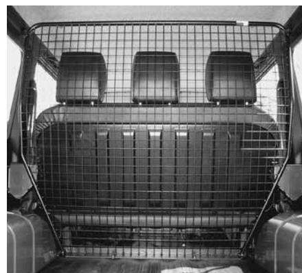
Trennwand B hinter 3er-Sitzbank
