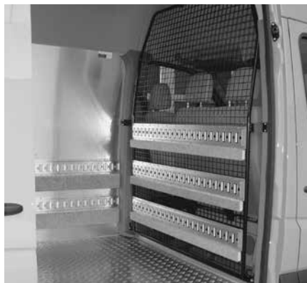
Trennwand B mit Ladegutsicherung
