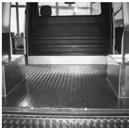
Riffelblechboden einteilig | Radkasten kubisch mit Bord | Seitenwandverkleidungen unten
