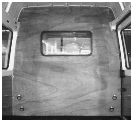
Trennwand C mit Fenster
