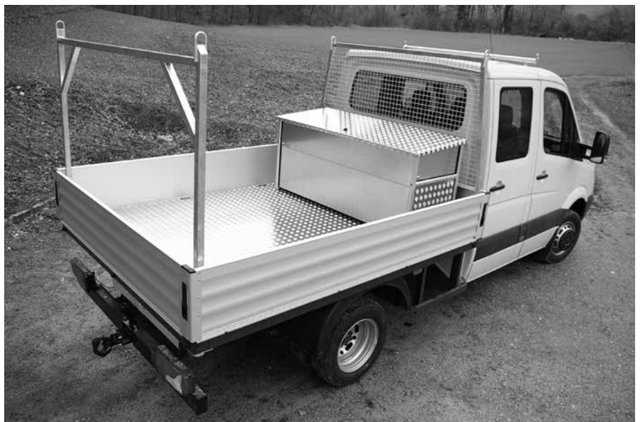
Stangenträger mit Werkzeugkasten
