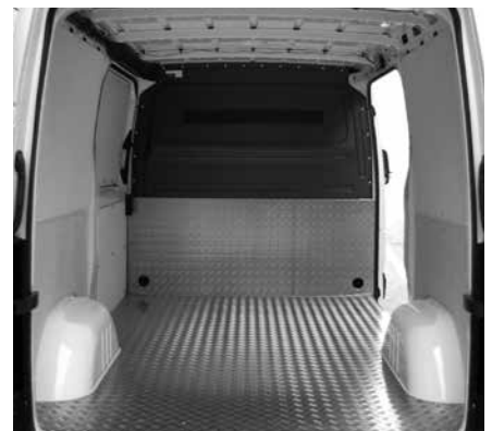
Trennwandverstärkung aus Alu-Riffelblech
