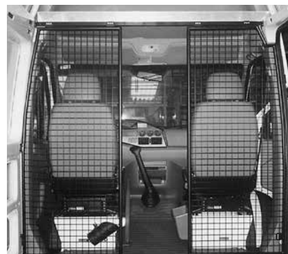
Paroi de séparation type B avec passage
