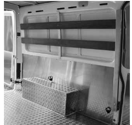
Riffelblechboden einteilig | Radkasten kubisch | Seitenwandverkleidungen unten | Hartholzlatzen oben
