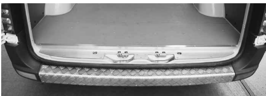
Türschwelle hinten anstelle Kunststoffteil und Stossbalkenschutz
