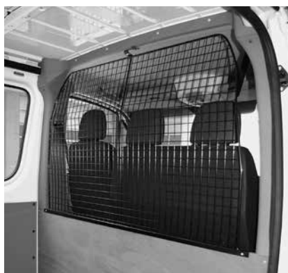
Trennwand A mit Gitter
