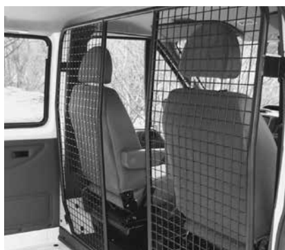
Paroi de séparation type B avec passage
