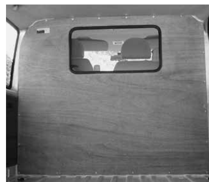
Paroi de séparation type C avec fenêtre
