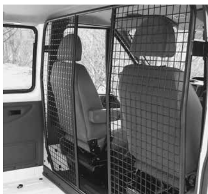
Trennwand B mit Durchgang
