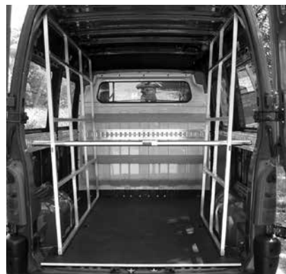
Innenreiff für Glastransport aus Aluminium
