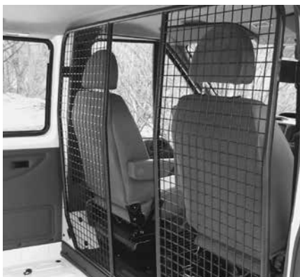
Paroi de séparation type B avec passage
