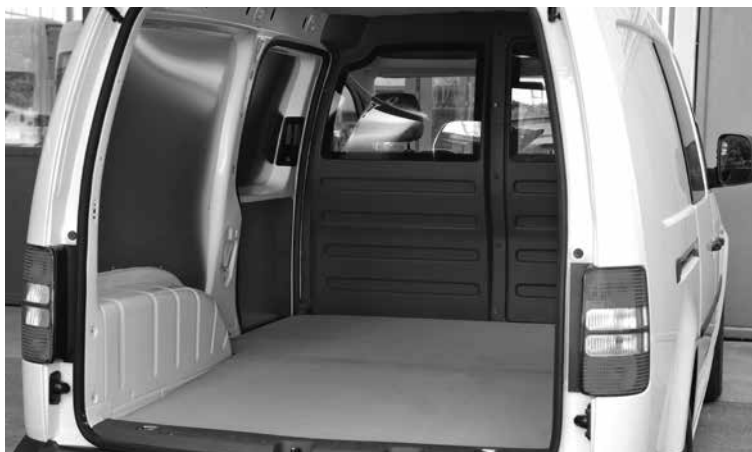
Revêtement du plancher et des parois latérales
