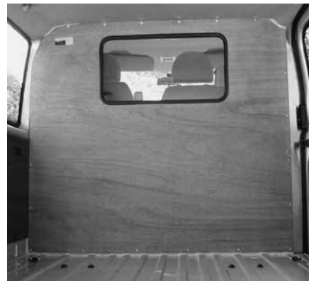
Trennwand C mit Fenster
