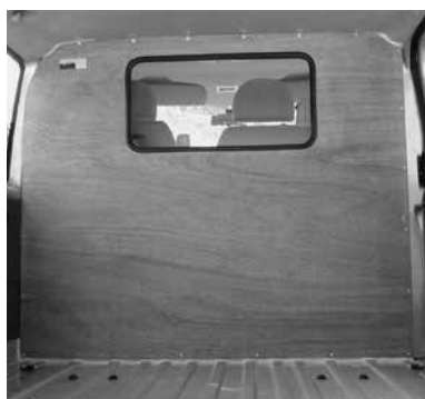
Paroi de séparation type C avec fenêtre
