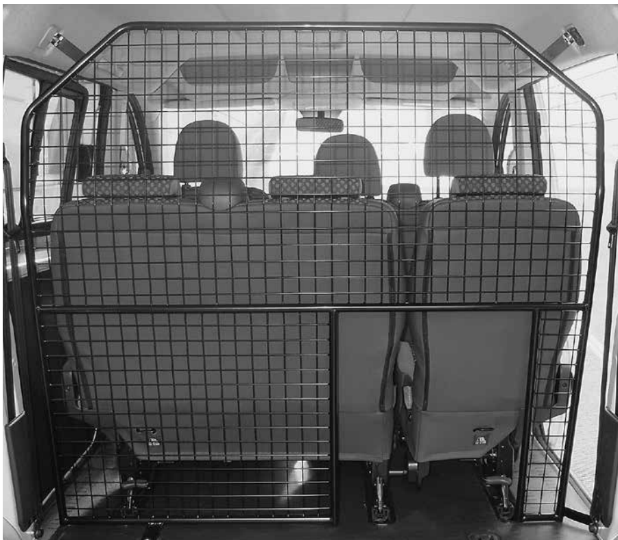
Exécution spéciale avec passage pour matériel
