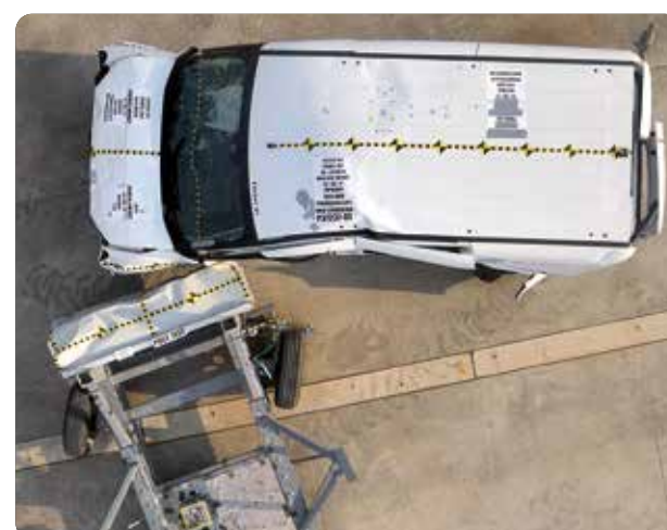
Essai de collision: Après collision latérale par un autre véhicule
