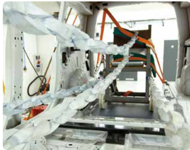
Zugversuche zur Prüfung der Rollstuhlverankerungen im Fahrzeug.
