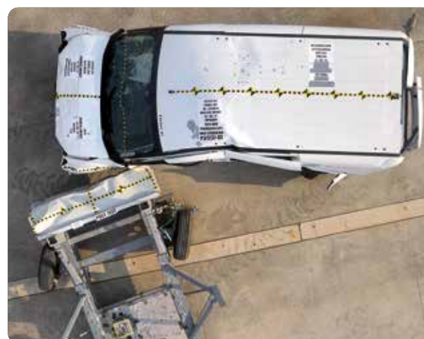
Crashtest: Nach dem Seitenaufprall durch ein anderes Fahrzeug
