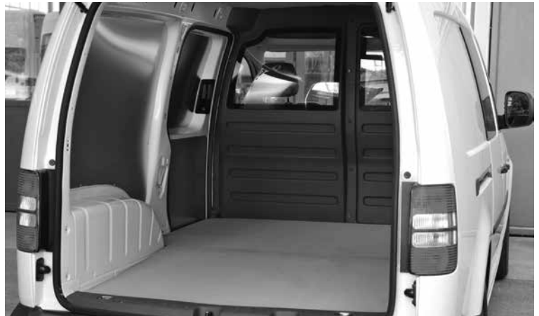
Revêtement du plancher et des parois latérales
