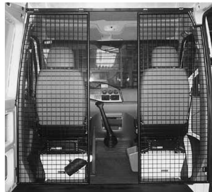
Paroi de séparation type B avec passage
