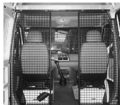
Paroi de séparation type B avec passage
