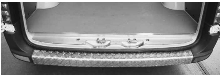
Seuil de porte à l'arrière au lieu d'un élément plastique et pare-chocs renforcé
