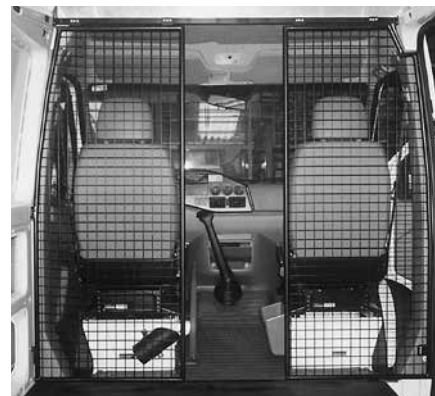
Paroi de séparation type B avec passage
