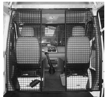
Trennwand B mit Durchgang
