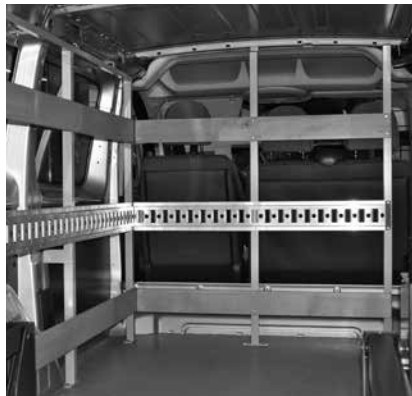
Ladegutsicherung für Essensbehälter
