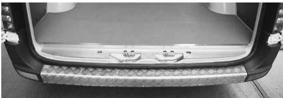
Türschwelle hinten anstelle Kunststoffteil und Stossbalkenschutz
