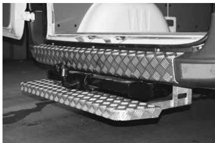
Hecktritt und Stossbalkenschutz
