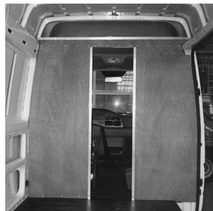
Trennwand C mit Durchgang spezial
