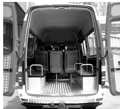
Véhicule de transport d'équipe avec banquettes longitudinales
