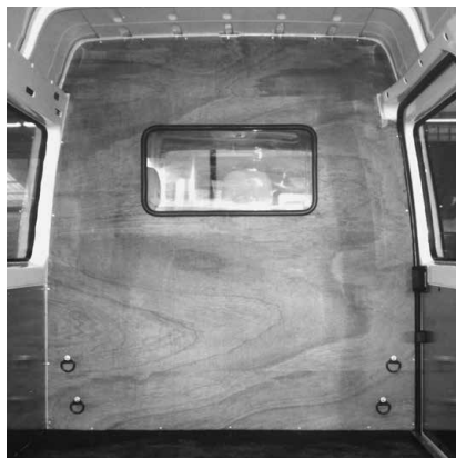
Paroi de séparation type C avec fenêtre
