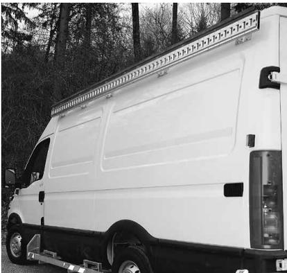
Seitlicher Lastenträger zum Beispiel für den Transport von Toren
