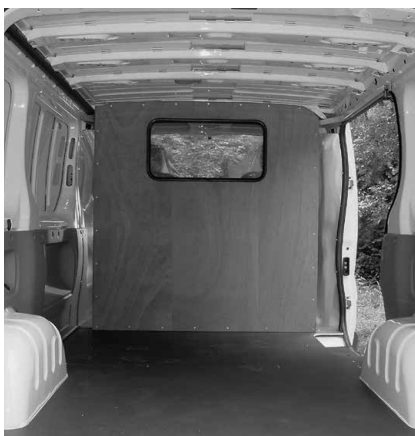
Paroi de séparation C
