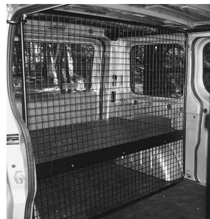
Paroi de séparation grillagée avec surface de chargement
