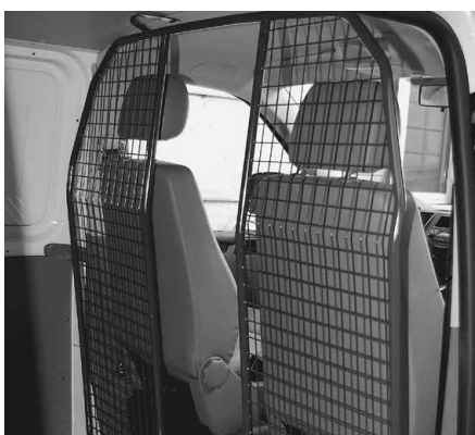
Paroi de séparation B avec passage
