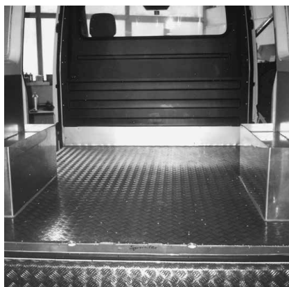
Plancher en tôle d'aluminium striée d'une pièce | Passage de roue de forme cubique avec bord | Revêtement des parois latérales en bas
