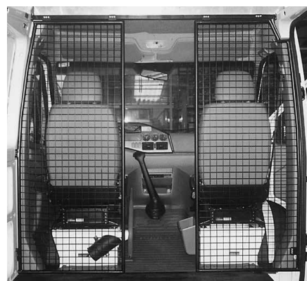
Paroi de séparation type B avec passage
