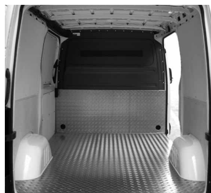
Renforcement de la paroi de séparation en tôle d'aluminium striée
