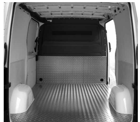
Trennwandverstärkung aus Alu-Riffelblech
