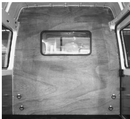
Trennwand C mit Fenster
