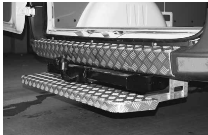
Hecktritt und Stossbalkenschutz
