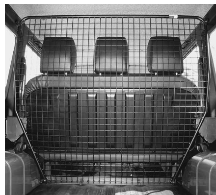
Trennwand B hinter 3er-Sitzbank
