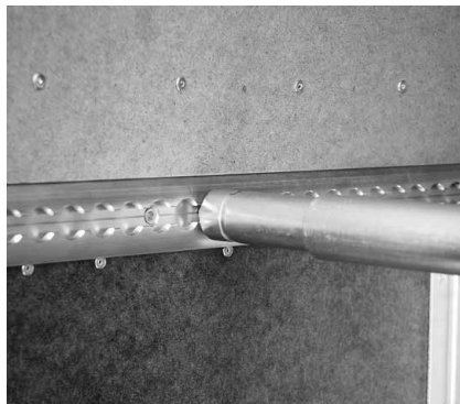
Airline-Zurrschiene mit Teleskop-Sperrstange
