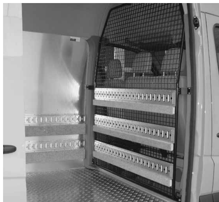
Trennwand B mit Ladegutsicherung
