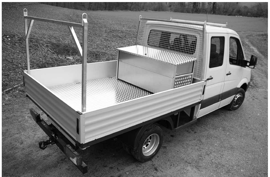
Stangenträger mit Werkzeugkasten
