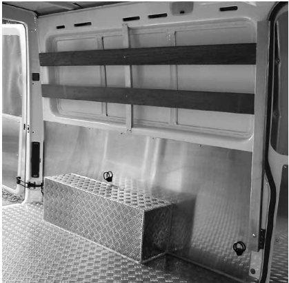
Riffelblechboden einteilig | Radkasten kubisch | Seitenwandverkleidungen unten | Hartholzlatten oben
