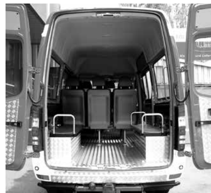
Véhicule de transport d'équipe avec banquettes longitudinales
