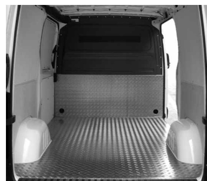
Renforcement de la paroi de séparation en tôle d'aluminium striée
