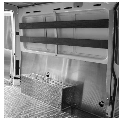
Plancher en tôle d'aluminium striée d'une pièce | Passage de roue de forme cubique | Revêtement des parois latérales en bas | Lattes en bois dur en haut
