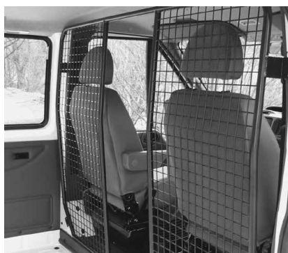
Paroi de séparation type B avec passage
