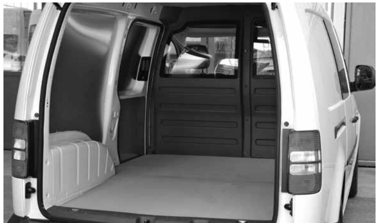
Revêtement du plancher et des parois latérales
