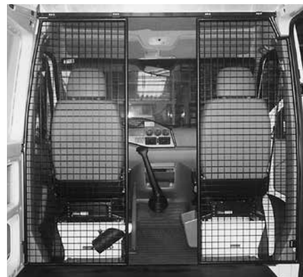
Paroi de séparation type B avec passage
