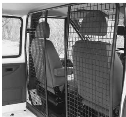
Paroi de séparation type B avec passage
